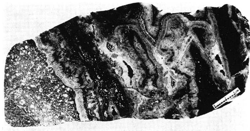
Рис. 2. Брекчиевидная текстура руд. Темно-серое и серое-окварцованные андезитовые порфириды, светло-серое — кварц разных генераций, белое-пирит, Палированный штуф 1/2 натур. величины.
