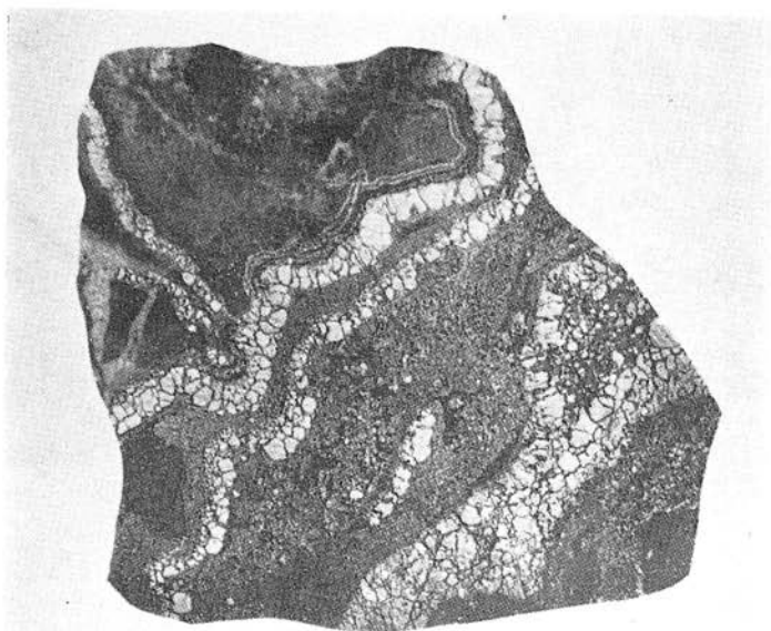
Рис. 6. Кварц-пиритовые агрегаты (светло-серое), образовавшиеся путем замещения андезитовых порфиров (серое и темно-серое), Полир. штуф, 1/2 натур. величины.
